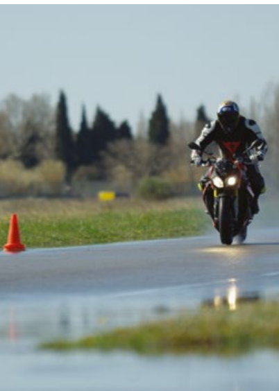
Os pneus são testados repetidamente em superfícies secas e molhadas
